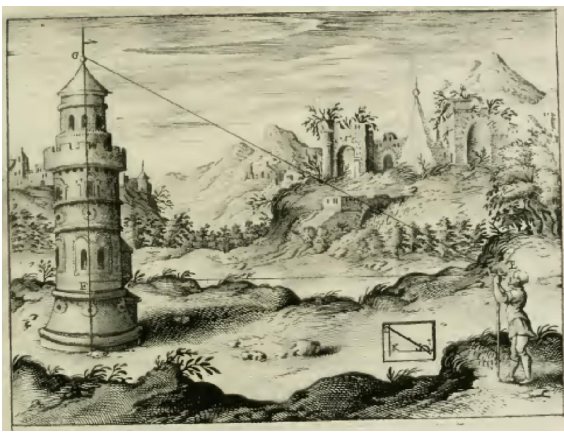
Utilisation du graphomètre pour la mesure de hauteur
